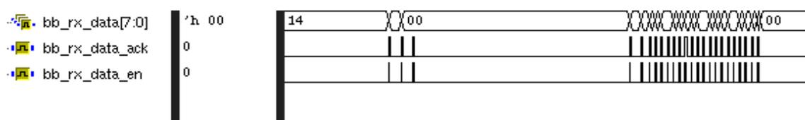
解决该问题的办法是在接口模块内部为输入输出数据通路设置一个合适深度的 FIFO，当 MAC 层的接收速度达不到 Baseband 的要求时，通过 FIFO 的存储深度来暂时保存数据，防止数据丢失，从而达到速率匹配的目的。
